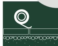
4. Nel caso di impermeabilizzazione del pavimento è necessario sigillare ciascun giunto di **MagicNet** con bandella **Magi-cband**.
